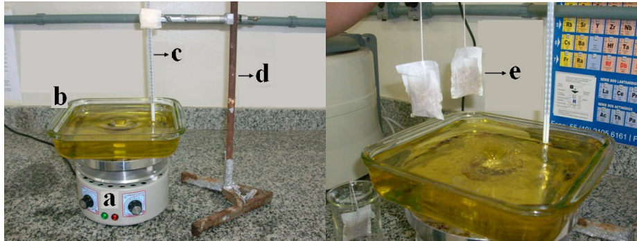
FIGURA 8: Montagem experimental do processo de fritura por imersão.
