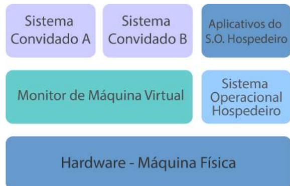
**Figura 2.3:** Monitor de Máquina Virtual Híbrida
