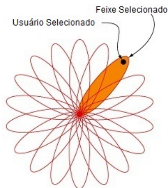
Figura 3.8: Sistema de antenas de feixe comutado ( Switched Beam ) (FRENZEL, 2005).
