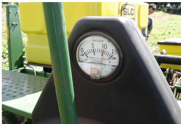
FIGURA 21. Vacuômetro das semeadoras 2 e 3 mostrando a pressão de vácuo em operação de semeadura.
