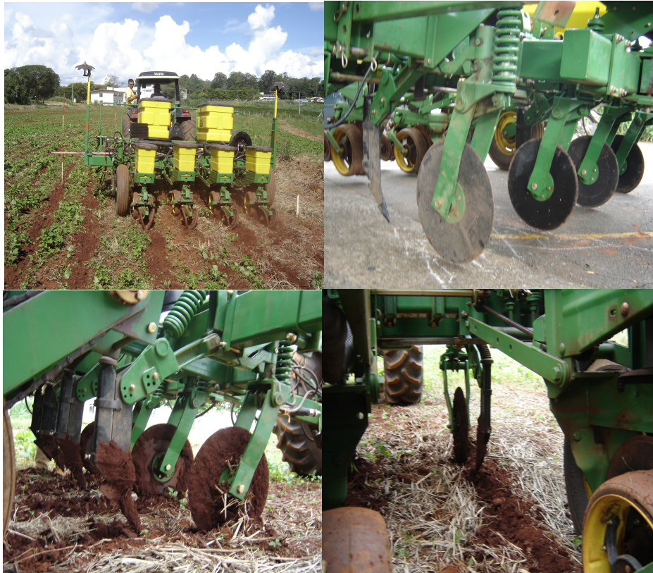
FIGURA 3. Semeadora 3 em operação de semeadura e detalhes de seus mecanismos.
