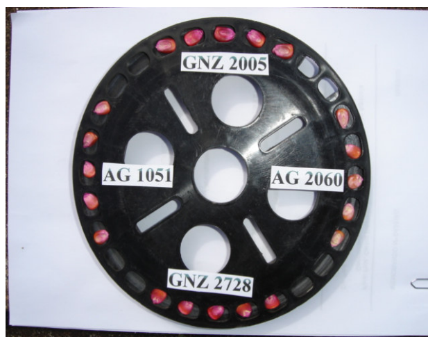
FIGURA 19. Seleção da semente nos furos do disco horizontal
