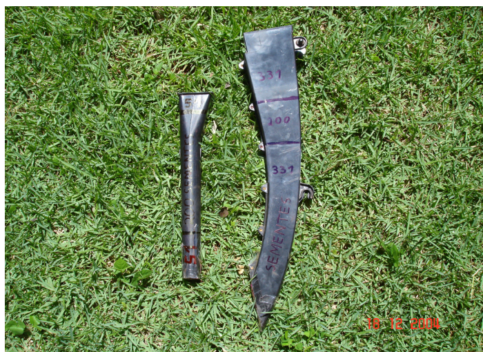
FIGURA 15. Tubos condutores e coletores de sementes: à esquerda S1; à S2 e S3.
