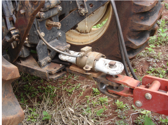
FIGURA 8. Célula de carga acoplando trator-semeadora.
