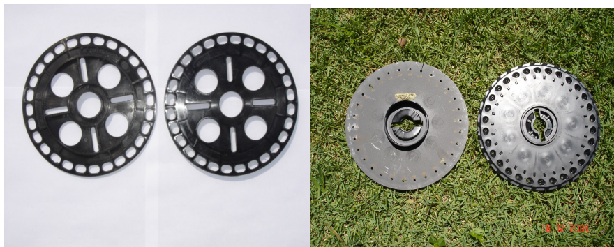
FIGURA 14. Disco da semeadora S1 à esquerda e das semeadoras S2 e S3 à direita (frente e verso).
