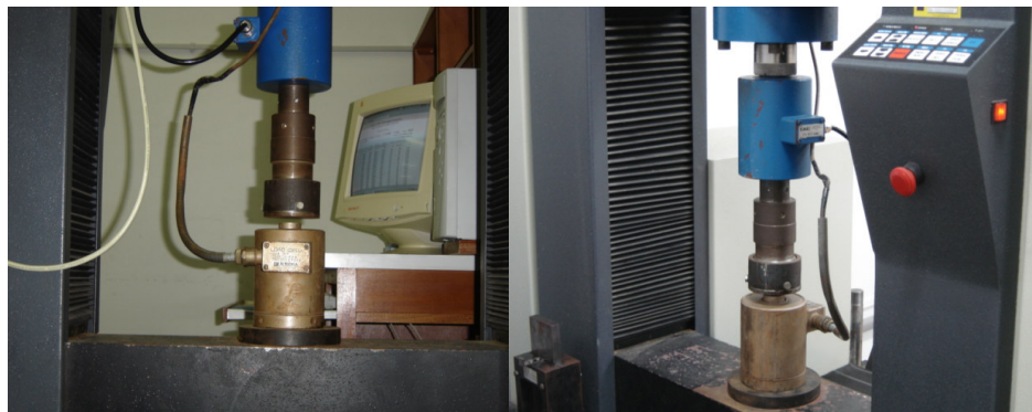
FIGURA 9. Máquina de ensaio universal aferindo célula de carga.
