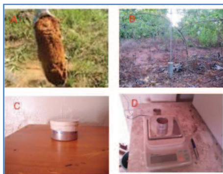
FIGURA 2. Equipamentos utilizados na coleta de solo para a análise de fertilidade, textura e resistência do solo à penetração: A) Trado holandês. B) Penetrômetro de impacto Modelo IAA/Planalsucar. C) Recipientes de alumínio. D) Balança analítica.
