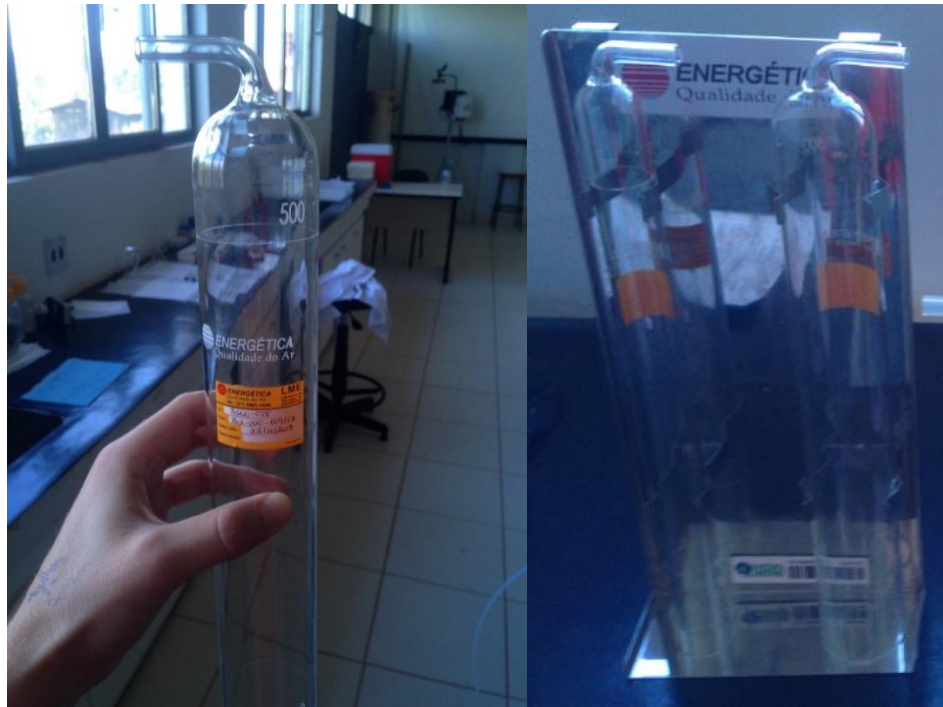
Figura 6: Bolhômetros utilizados para ensaio dos orifícios críticos
