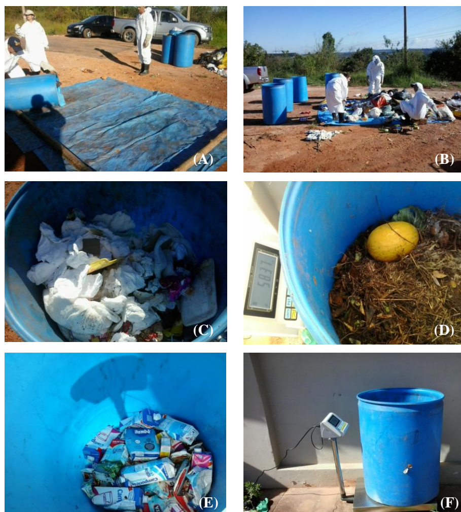
Figura 1 Diferentes etapas do quarteamento e caracterização gravimétrica dos resíduos sólidos domiciliares de diferentes bairros de Lavras: (A) início do processo de quarteamento dos resíduos sobre lona plástica, (B) início da separação dos resíduos, (C), (D) e (E) separação dos plásticos, matéria orgânica e embalagens tetra pak, (F) pesagem individual de cada componente dos resíduos sólidos
