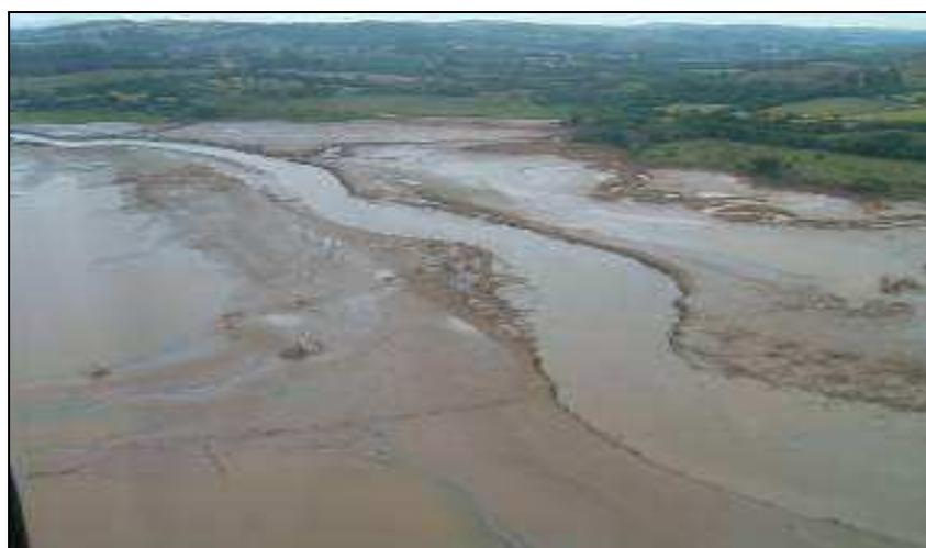
Figura 13 Assoreamento identificado no rio Capivari, em junho de 2008, durante o rebaixamento do reservatório
