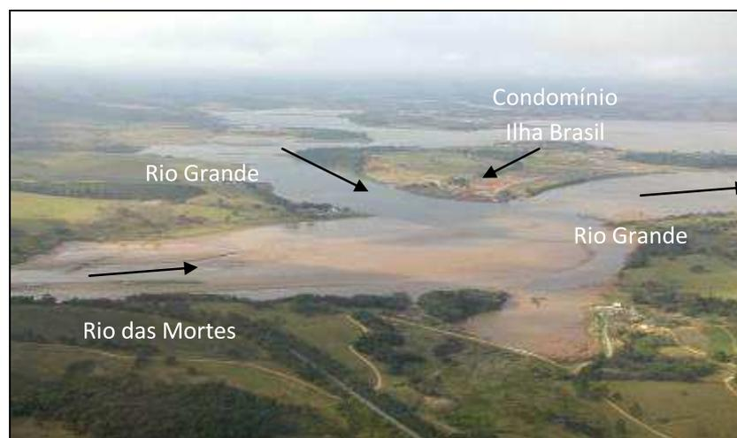
Figura 12 Assoreamento identificado na confluência do rio Grande com o rio das Mortes, em junho de 2008, durante o rebaixamento do reservatório
