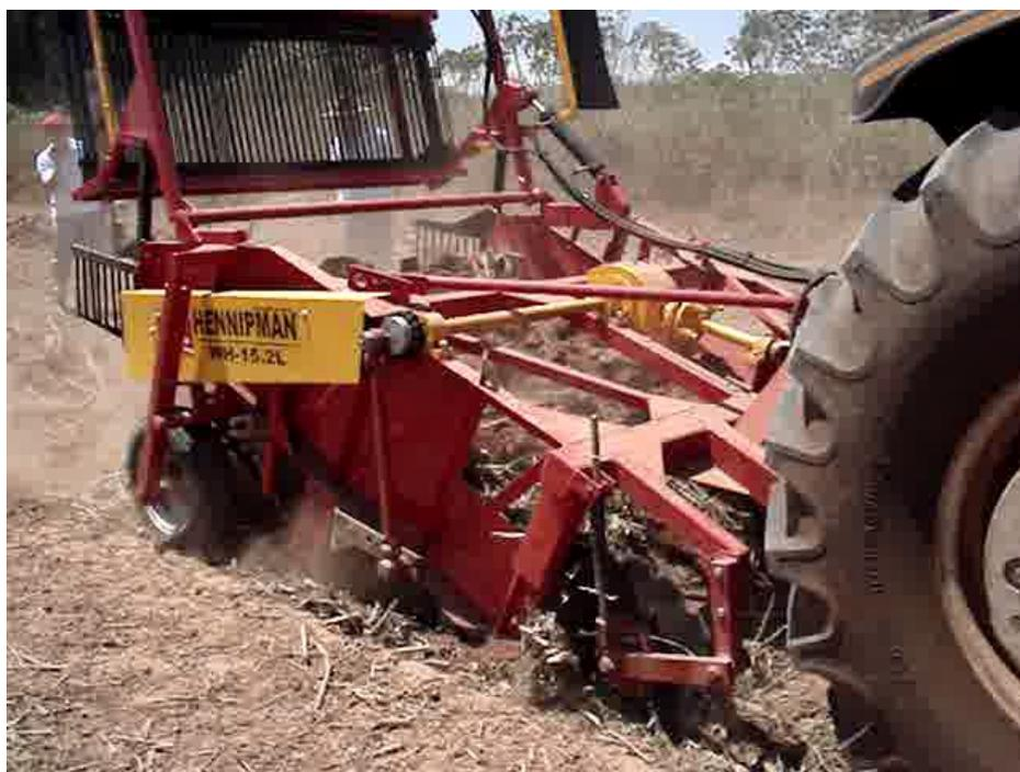
FIGURA 3 Arrancadora utilizada na colheita.
