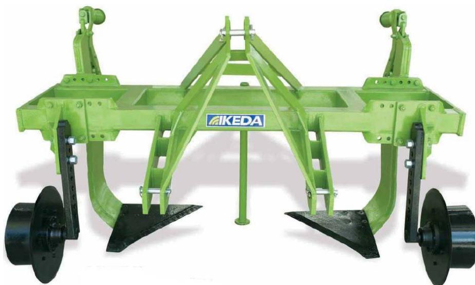
FIGURA 2 Modelo do afofador de solo utilizado na colheita.
