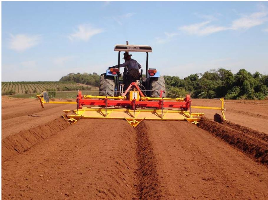
FIGURA 1 Fresadora encanteiradora utilizada no levantamento de canteiros.
