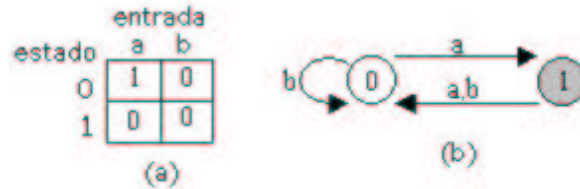
Figura 5: Um autômato finito com conjunto de estados Q = \{0, 1\} , estado inicial q_0 = 0 , e alfabeto de entrada \Sigma = \{a, b\} . (a) representação tabular da função de transição \delta . (b) diagrama dos estados de transição equivalente.
