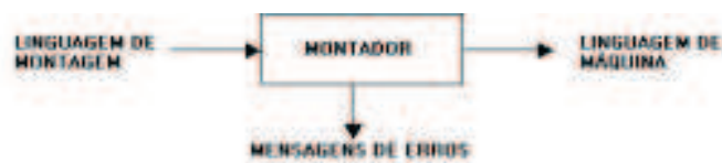
Figura 3.10: Processo de montagem
