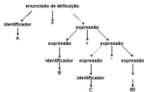
Figura 3.6: Árvore gramatical para A = B + C * 60
