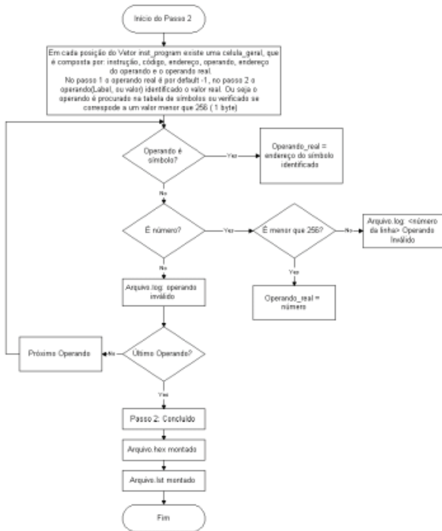
Figura 6.5: Processo de montagem - Fase 3
