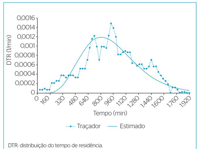
**Figura 3 - Curva e ajuste da distribuição do tempo de residência pela função gama no 1º teste, totalizando 32 horas (1.920 minutos).**
