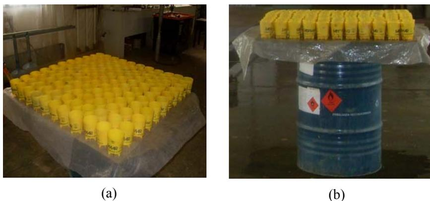
Figura 9 (a) Posicionamento dos coletores dentro da malha; (b) altura da malha em relação à superfície do solo
