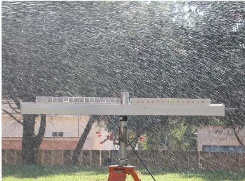
Figura 1 Sistema dinâmico de pluviometria (SDP)
