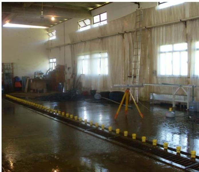
Figura 7 Determinação do padrão molhado
