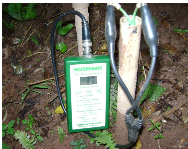
FIGURA 4. Detalhes de sensores de umidade do solo instalados em área sob Mata Atlântica na região da Serra da Mantiqueira, MG.
