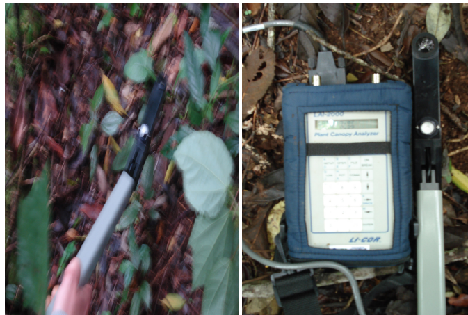
FIGURA 6. LAI-2000 utilizado para medição do índice de área foliar.
