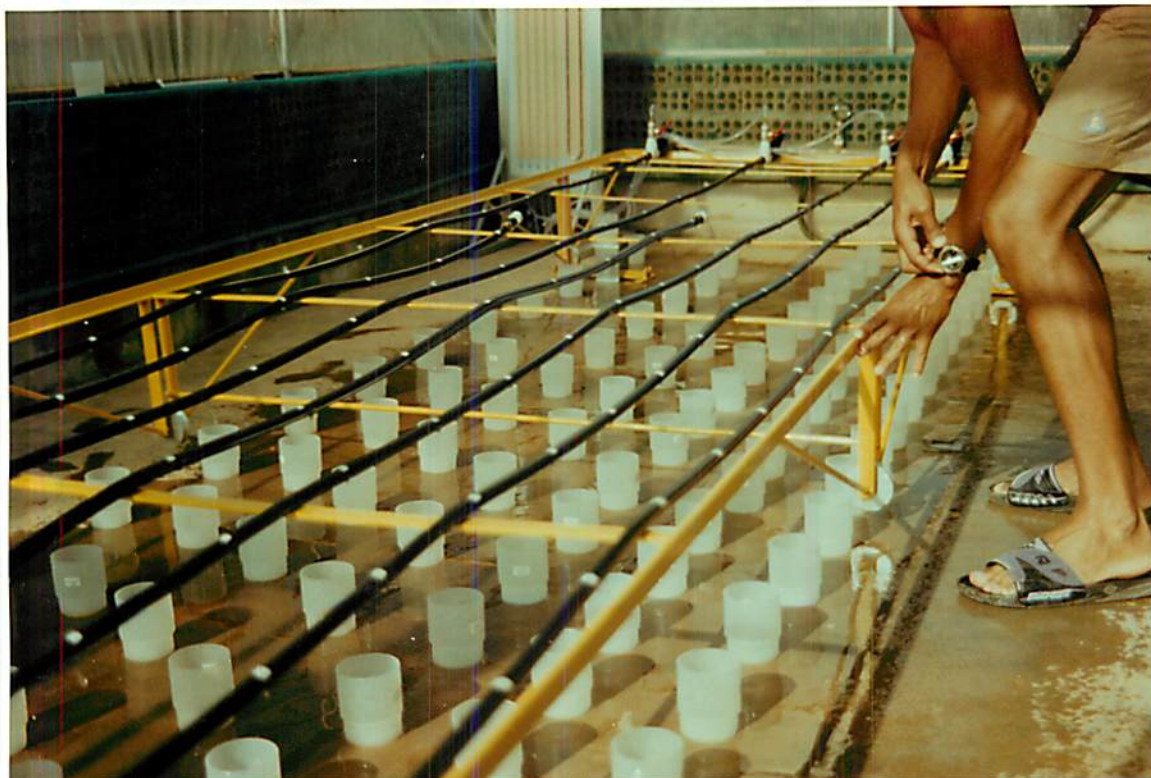
FIGURA 3. Vista dos coletores mostrando o momento do deslocamento da bancada de teste para coletar os volumes de água dos 125 emissores simultaneamente.
