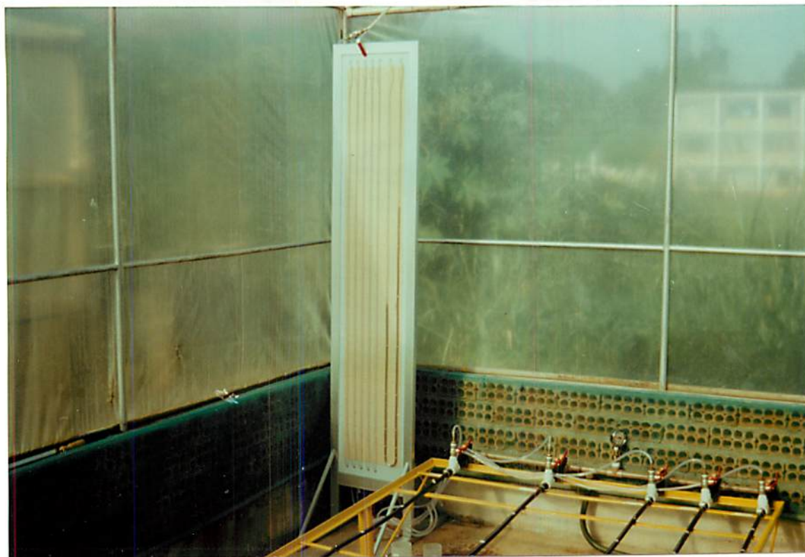
FIGURA 2. Vista frontal do painel com manômetro de mercúrio em U conjugado com manômetro de água.
