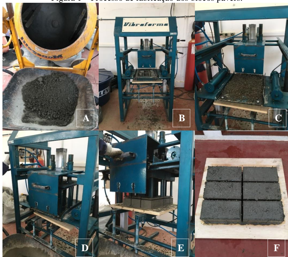
Figura 1 – Processo de fabricação dos blocos pavers.
