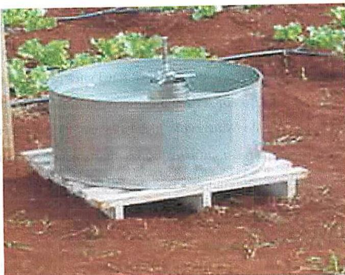
FIGURA 5. Minitanque evaporimétrico utilizado no experimento. UFLA, Lavras, MG, 2005.
