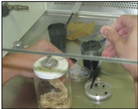
FIGURA 32 Plaqueamento do lodo dos reatores RAC e UASB.
