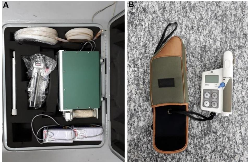
Legenda: A = analisador portátil de fotossíntese modelo LI-6400 (IRGA); B = medidor portátil de clorofila (SPAD-502).
