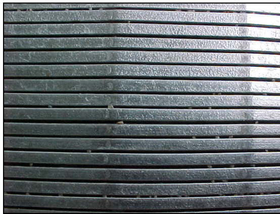
FIGURA 12 Detalhe da malha da peneira estacionária
