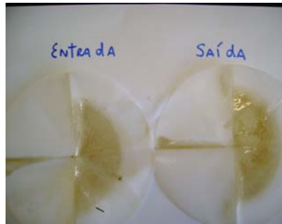
FIGURA 17D Sólido filtrado-entrada/saída
