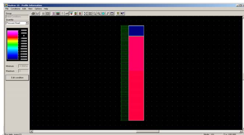
Figura 12 Condição inicial com distribuição dos potenciais mátricos no perfil do solo utilizadas nas simulações
