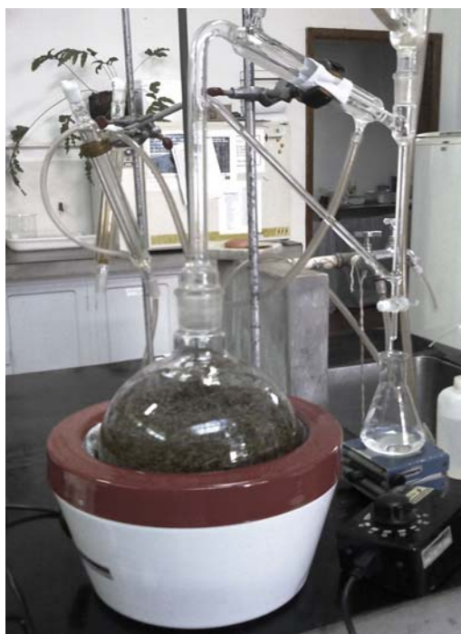
Figura 9 Aparelho de Clevenger modificado, utilizado na extração dos óleos essenciais
