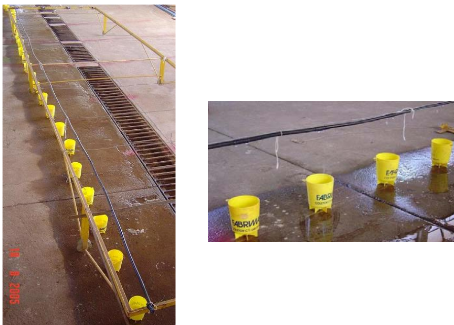
FIGURA 6 Arranjo do tubo gotejador para testes laboratoriais
