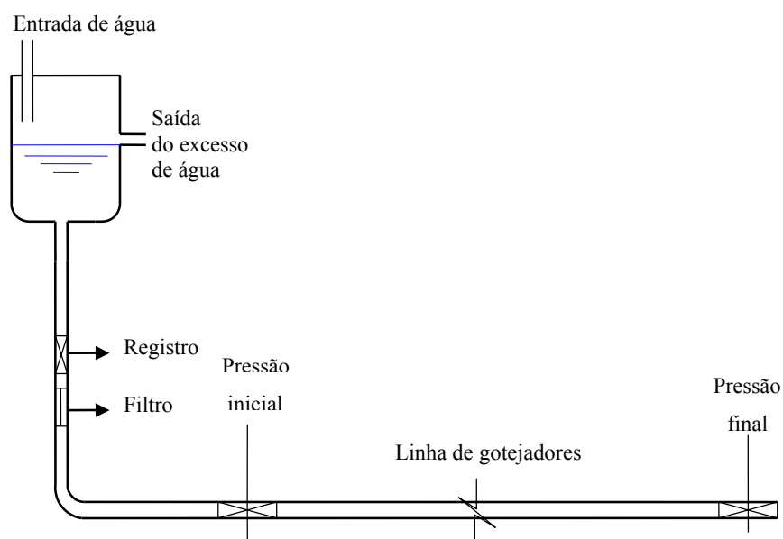
FIGURA 5 Bancada de testes para caracterização dos emissores
