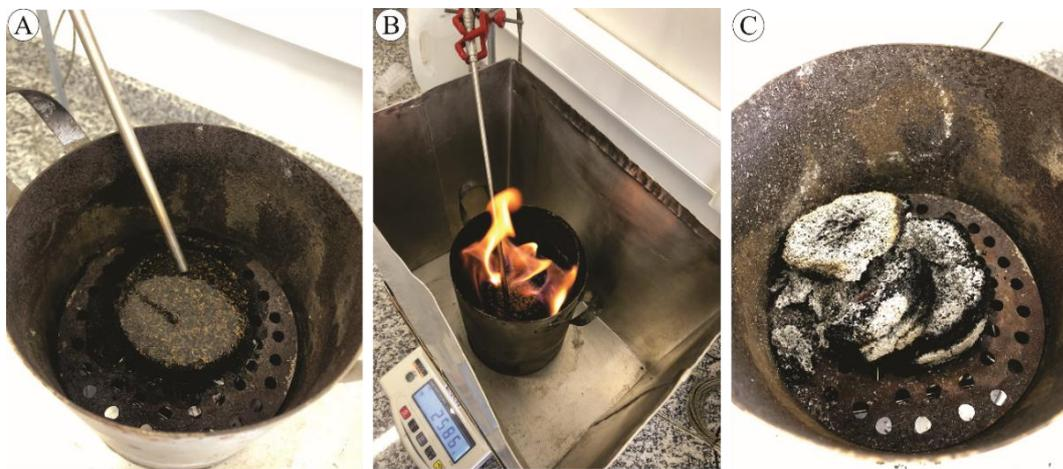
Figura 2 – Ensaio de combustão dos briquetes: (A) Briquete sobre o combustor; (B) Briquete em combustão; (C) Briquete desintegrado ao final do processo de combustão.
