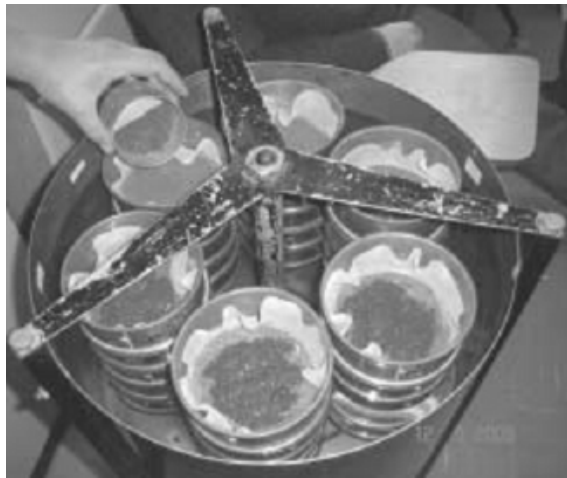
FIGURA 5B. Aparelhos de oscilação vertical para avaliação da estabilidade de agregados por peneiramento via úmida: a) aparelho composto por dois cilindros e dois conjuntos de peneiras; b) vista superior de um aparelho composto por um único cilindro com capacidade para seis conjuntos de peneiras.
