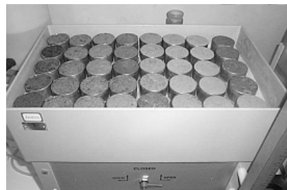
FIGURA 8B. Mesa de tensão utilizada na determinação das curvas de retenção de água dos solos (baixas tensões): a) desenho esquemático; b) amostras de solo em uma mesa de tensão.
