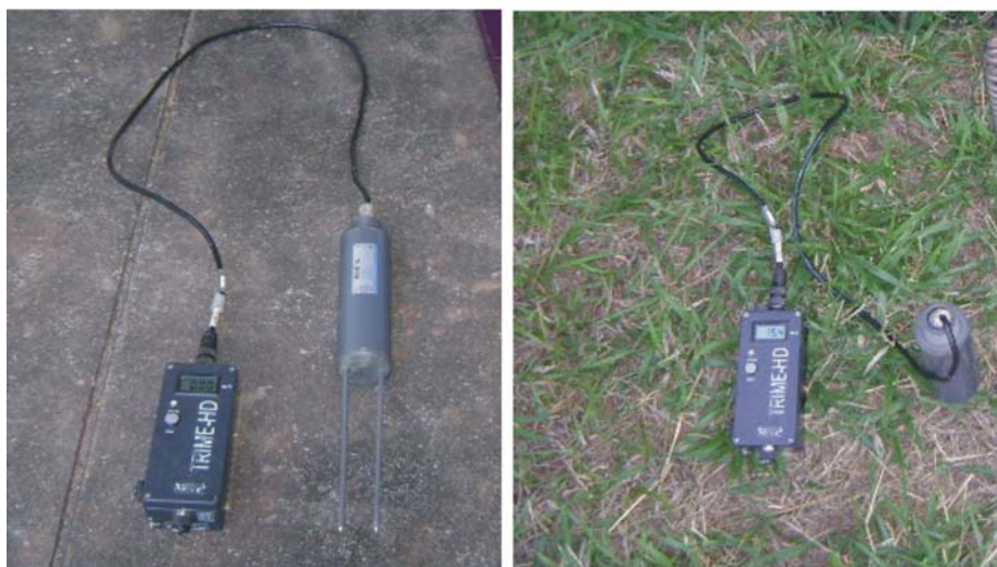
FIGURA 1 Equipamento portátil TDR ( Times Domain Reflectometry ) utilizado para o monitoramento da umidade do solo na bacia hidrográfica do ribeirão Lavrinha, na Serra da Mantiqueira, Minas Gerais.
