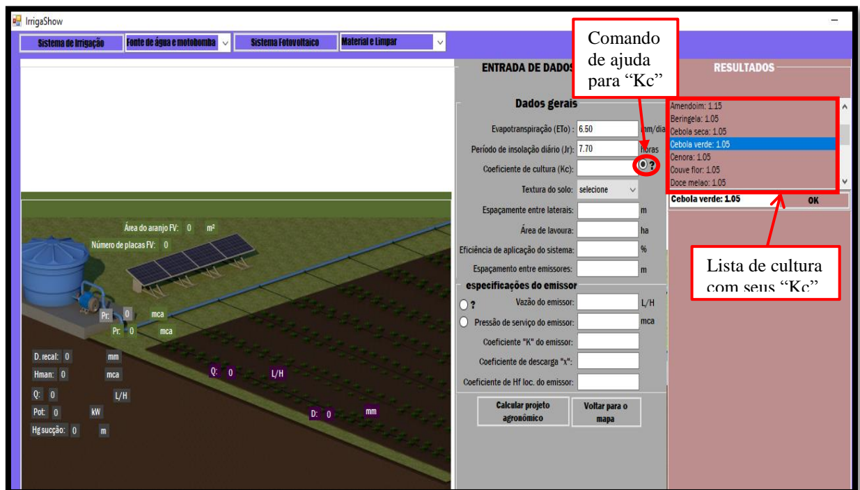
Figura 9 - Imagem da tela do software, quando o usuário seleciona o comando de ajuda, para a obtenção de coeficientes de algumas culturas.
