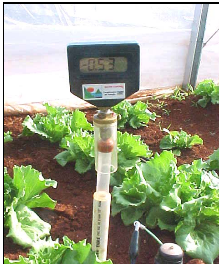
FIGURA 3 Tensímetro digital de punção inserido em um tensiômetro. UFLA, Lavras, MG, 2007.
