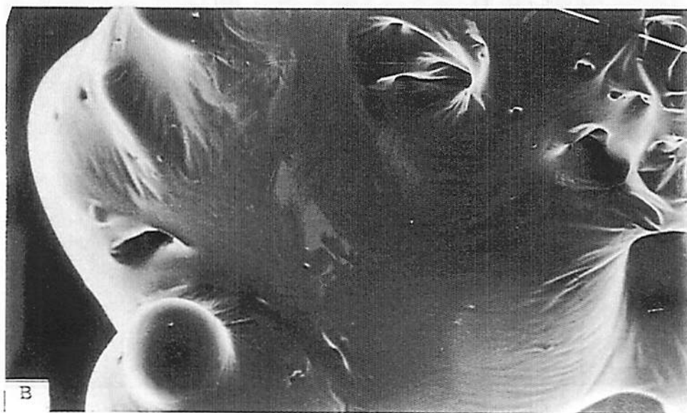
FIGURA 20 Fotomicrografia obtida no microscópio eletrônico de varredura de pós obtidos por atomização, após atingir um estado de aglomeração: A) suco de maracujá + MD-10 (x 2000 ) e B) suco de maracujá + MD-20. (x200 – 10kV)
