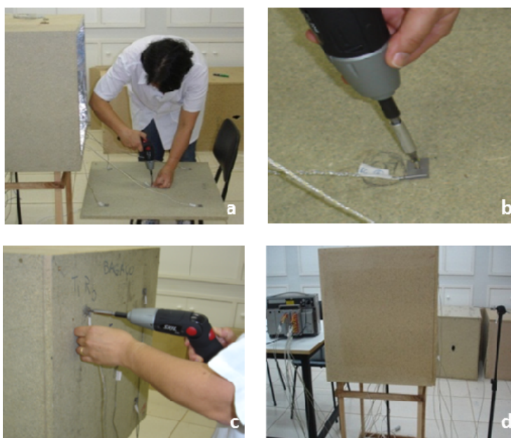
Figura 15 Processo de montagem dos termopares: a) internos; b) detalhe de fixação, c) externos; d) montagem final dos termopares
