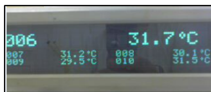
Figura 18 Tela de controle dos termopares externos de contato
