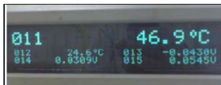
Figura 19 Tela de controle dos termopares de ambiente interno (11) e externo (12)
