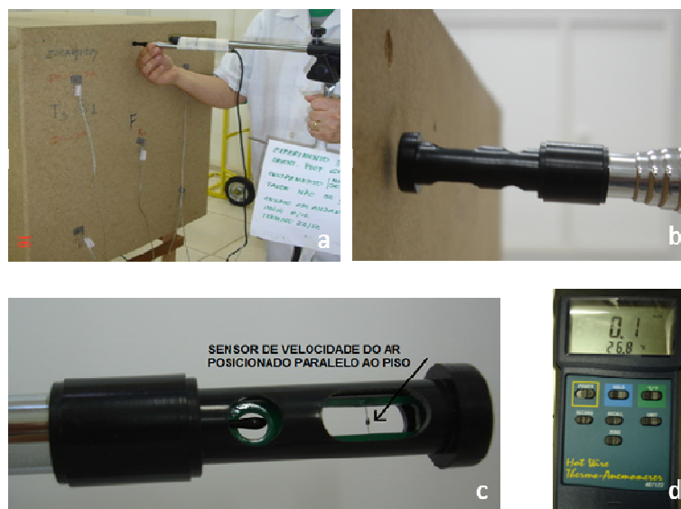
Figura 20 a) Posicionamento do aparelho em relação ao painel; b) distância aproximada do painel; c) detalhe do dispositivo que capta a velocidade do ar próximo ao painel; d) leitor de velocidade do ar em (m/s)
