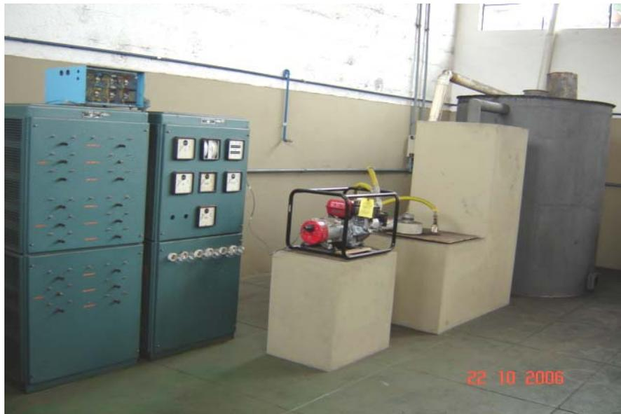
FIGURA 5 Conjunto gaseificador-gerador, painel de cargas.
