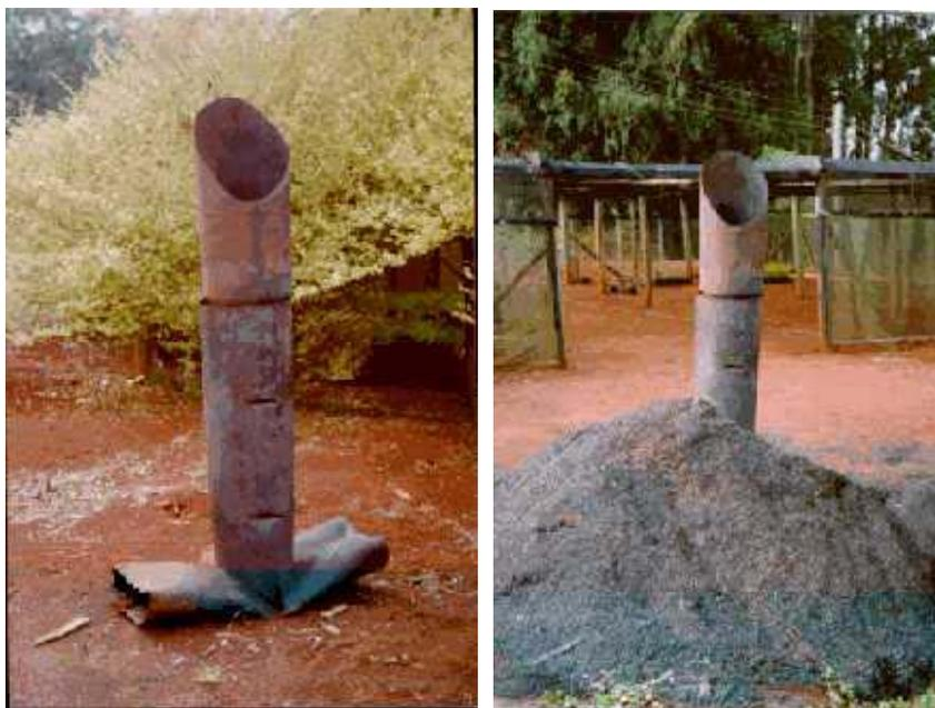
FIGURA 6 Chaminé construída com chapas metálicas soldadas
