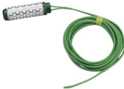
FIGURA 6 Sensor de umidade do solo da marca Watermark ® .
