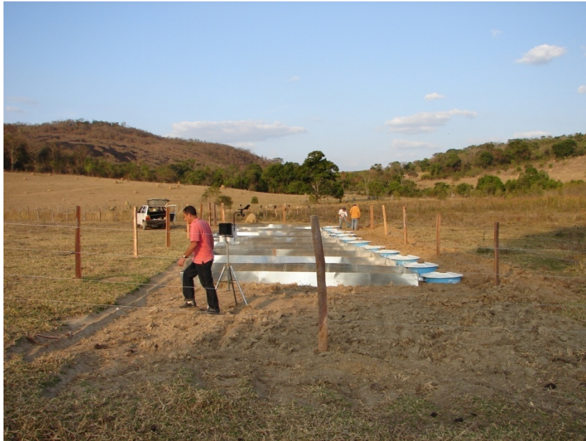
FIGURA 1 Parcelas de perdas de solo instaladas na área de proteção ambiental (APA), Coqueiral, MG, para estudo da dinâmica da atrazina no solo.
