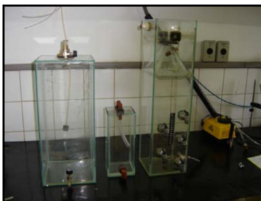
FIGURA 3 Gasômetro, equalizador de pressão e reator UASB
