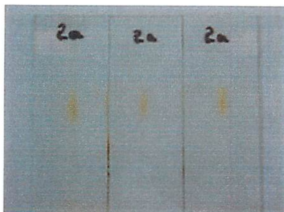
FIGURA 52. Cromatogramas da amostra 3 desenvolvidas em metanol e ácido acético 3:7 e reveladas à exposição a vapores de iodo. UFLA/DQI, Lavras - MG, 2002.
