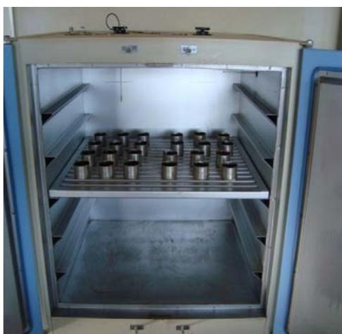
FIGURA 1A Amostras de solo para determinar a umidade
