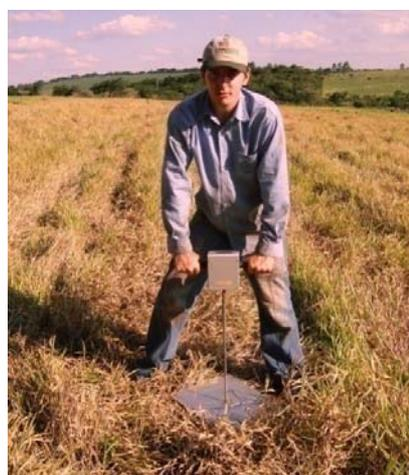
FIGURA 1B Ensaio da resistência à penetração do solo
