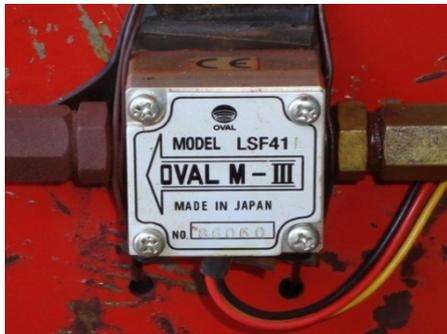
FIGURA 8A Fluxômetro eletromecânico
