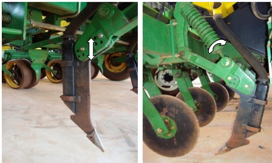
FIGURA 5A Acoplamento da haste Sulcadora
