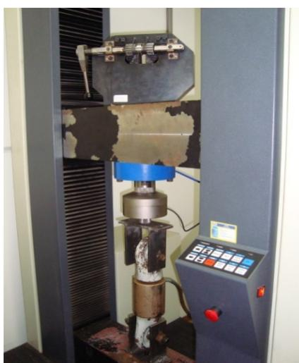
FIGURA 6 Calibração da célula de carga na máquina de ensaio universal
