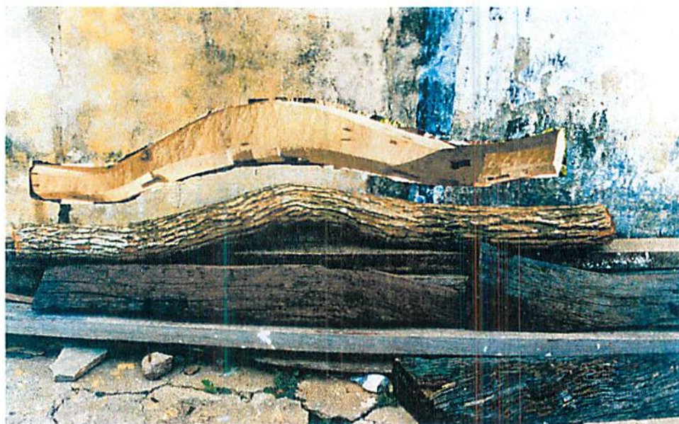
FIGURA 3.6. Canga e madeira de Platypodium elegans (jacarandazinho) no formato da canga, usado na fabricação dessa peça do carro de bois.
