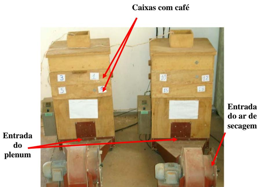
FIGURA 5 Vista frontal dos secadores protótipos de camada fixa
