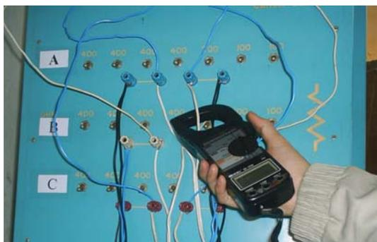
**FIGURA 17** Medição das correntes solicitadas pelas cargas. Laboratório de Hidráulica da UFLA, Lavras, MG, 2006.
