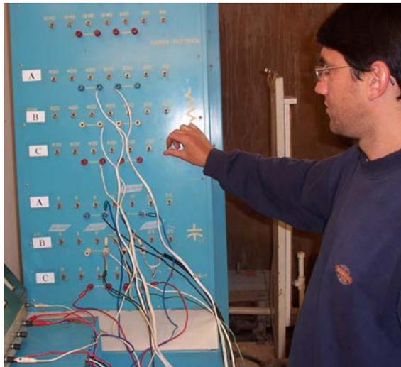
**FIGURA 14** Painel de cargas resistivas, indutivas e capacitivas.
