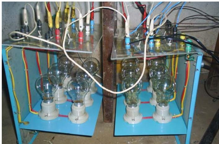
**FIGURA 15** Painel de lâmpadas utilizado como carga resistiva.
