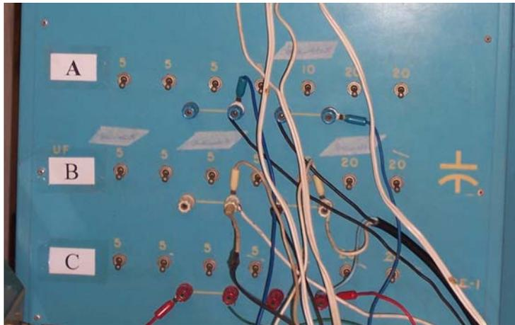
**FIGURA 16** Banco de capacitores chaveados. Laboratório de Hidráulica da UFLA, Lavras, MG, 2006
