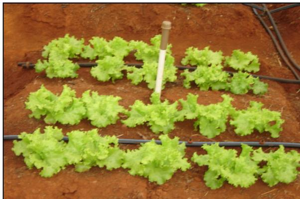
**FIGURA 3.** Tensiômetro instalado no centro de uma parcela experimental. UFLA, Lavras, MG, 2006.
