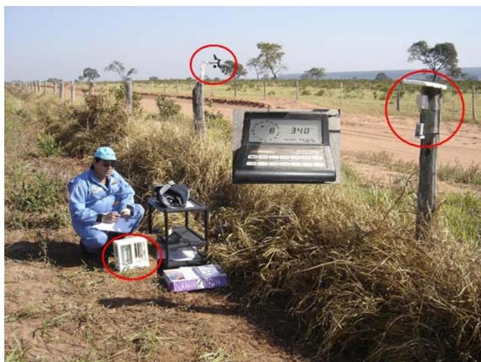
**FIGURA 7** - Estação meteorológica portátil da marca Davis, modelo Weather, Monitor II e termo-higrógrafo
