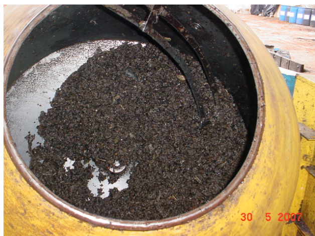
FIGURA 7. Betoneira usada para mistura de compostagem.
