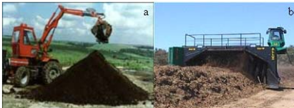
FIGURA 3. a) Leira revolvida por um trator tipo pá carregadeira. b) Leira revolvida por um compostador.
