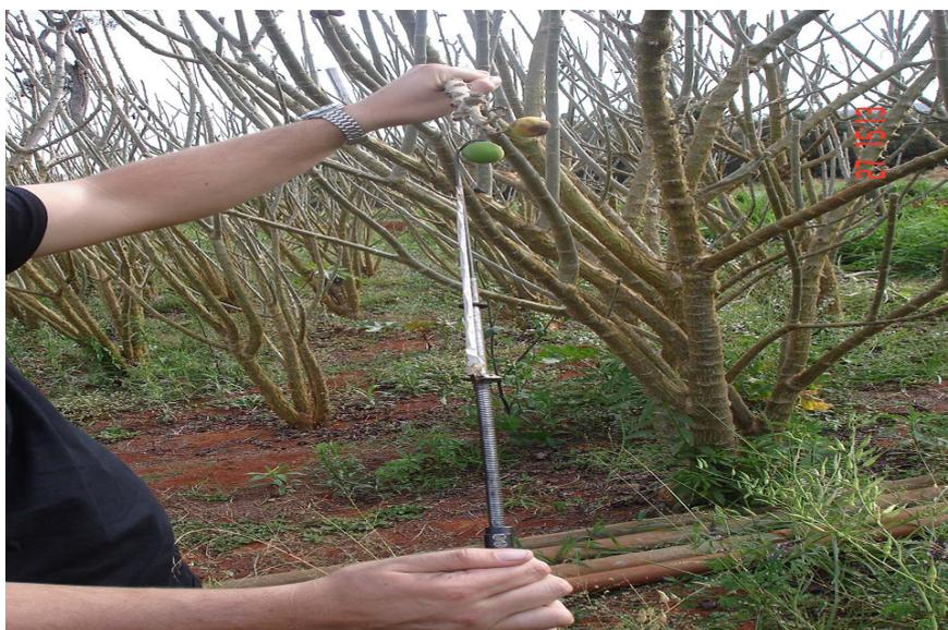
FIGURA 22 Dinamometro portatil em operação no campo.
