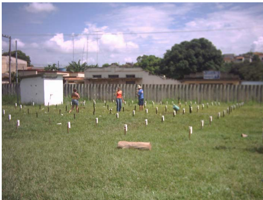
FIGURA 5 – Medição dos volumes de água contidos em cada coletor, após o término da irrigação
