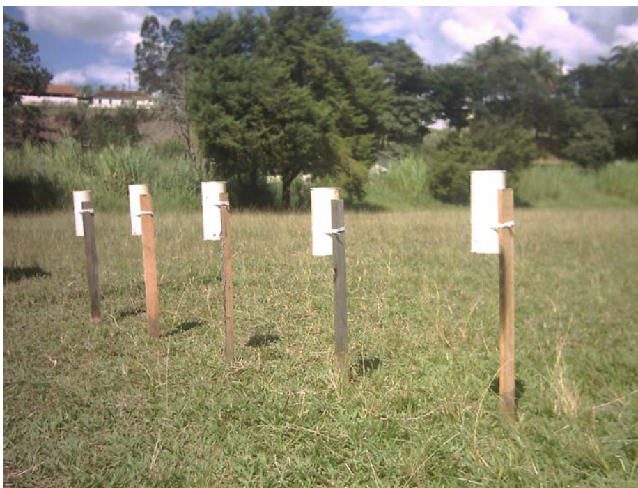
FIGURA 6 – Coletores de referência para estimar a evaporação durante o processo de leitura dos dados
