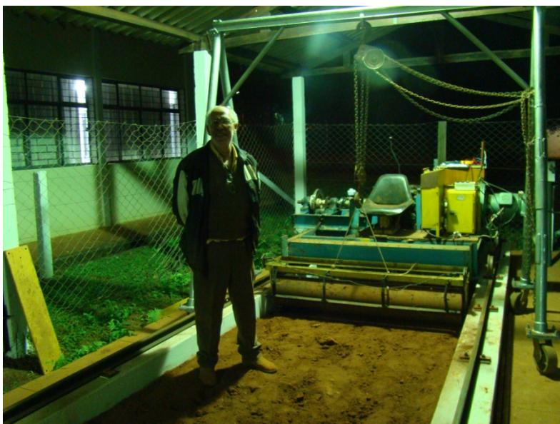
Figura 17 Rolo compactador acoplado ao carro dinâmico. Observa-se a condição do solo compactado
