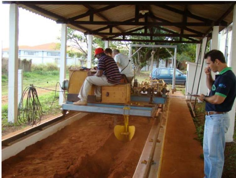
Figura 21 Medição da velocidade de deslocamento do carro dinamométrico. Observa-se o sulco aberto por ferramenta em ensaio com cronometragem digital
