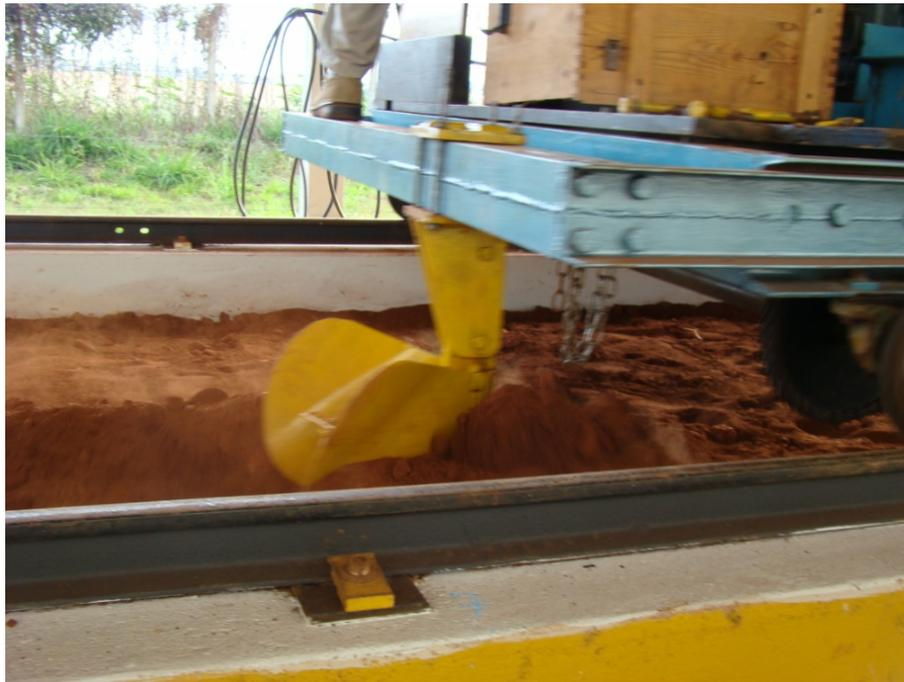
Figura 25 Sulcador em operação, vista lateral
