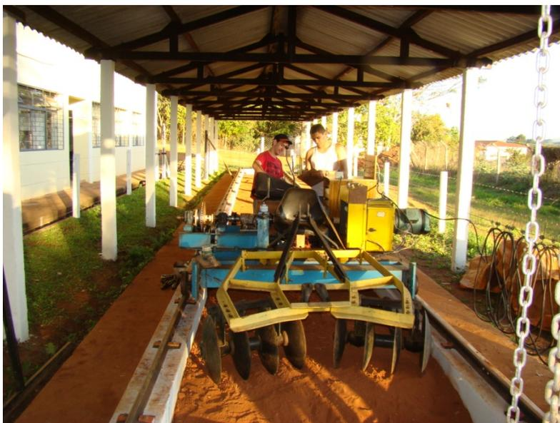
Figura 16 Grade niveladora acoplada ao carro dinâmico, vista anterior
