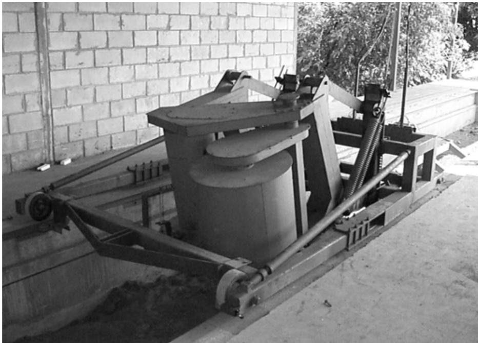
Figura 4 Cortador de base montado no carro porta ferramentas sobre a caixa de solo
