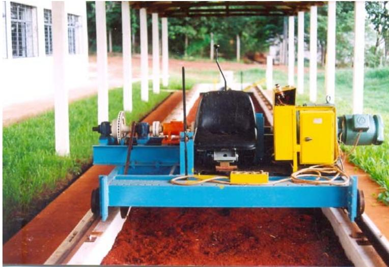
Figura 12 Fonte de potência, constituída por motor elétrico; quadro de comando; comando e proteção; módulo de controle do variador eletromagnético; banco do operador; alavanca do freio; roda dentada e corrente; e sistema de frenagem, vista anterior (da direita para esquerda)
