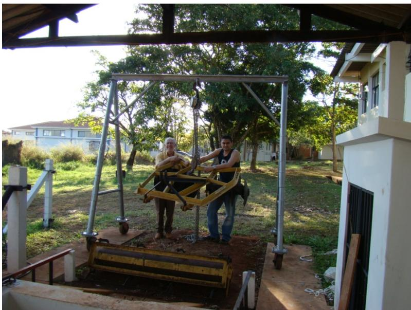
Figura 14 Grade niveladora sendo transportada em sistema de talha para acoplamento ao carro dinamométrico
