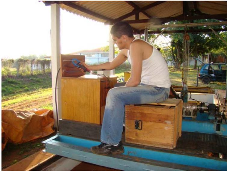
Figura 20 Medição de potência do motor elétrico com watímetro
