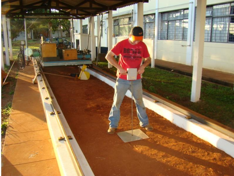
Figura 22 Ensaio de resistência à penetração, com o penetrômetro eletrônico
