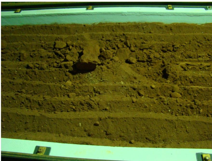
Figura 24 Solo preparado pela ação da grade niveladora
