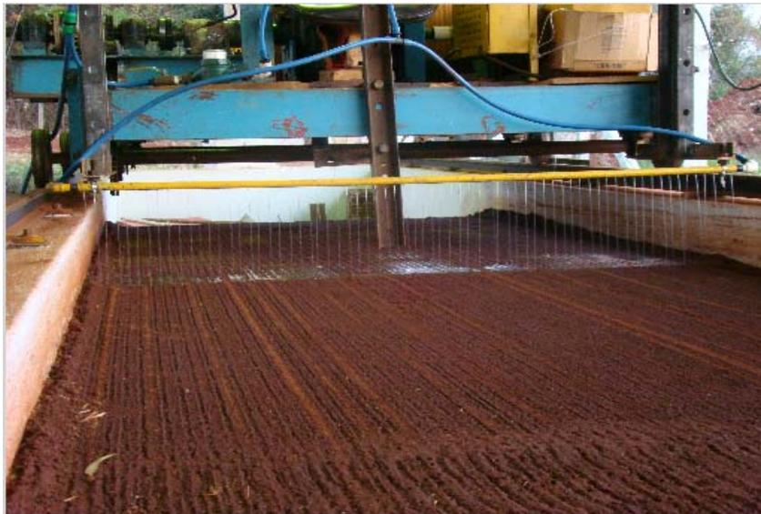
Figura 18 Irrigação da caixa de solo, com vazão e velocidade controlada
