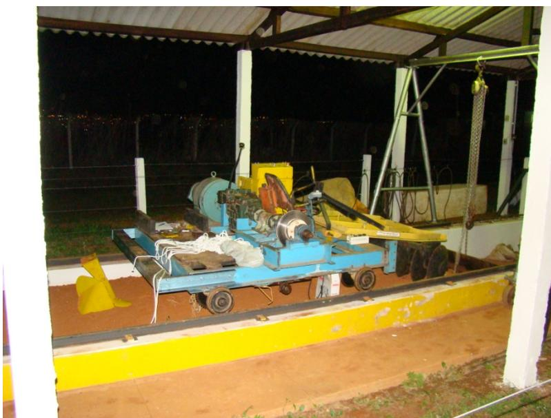
Figura 15 Grade niveladora acoplada ao carro dinamométrico, vista lateral
