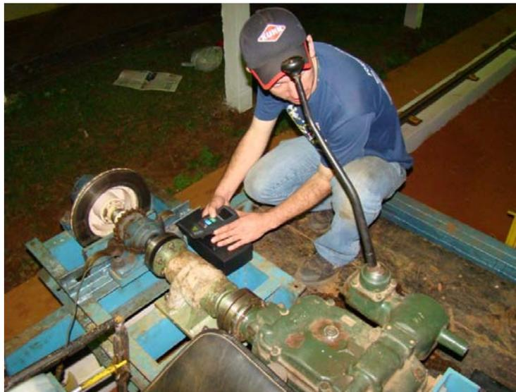
Figura 19 Medição de rotação do eixo de transmissão com tacômetro
