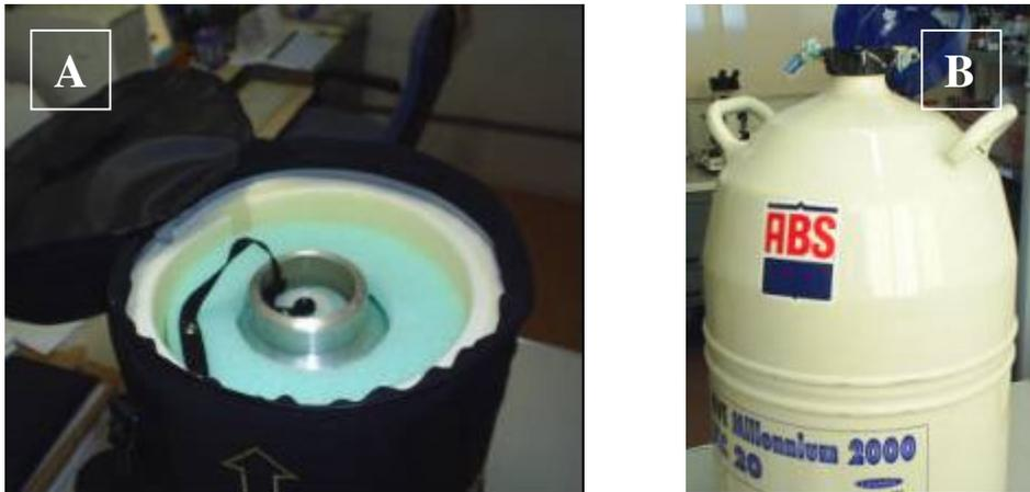
**FIGURA 5. A.** Botijão de vapor de nitrogênio líquido; **B.** Botijão de nitrogênio líquido (Foto: DZO – UFLA).
