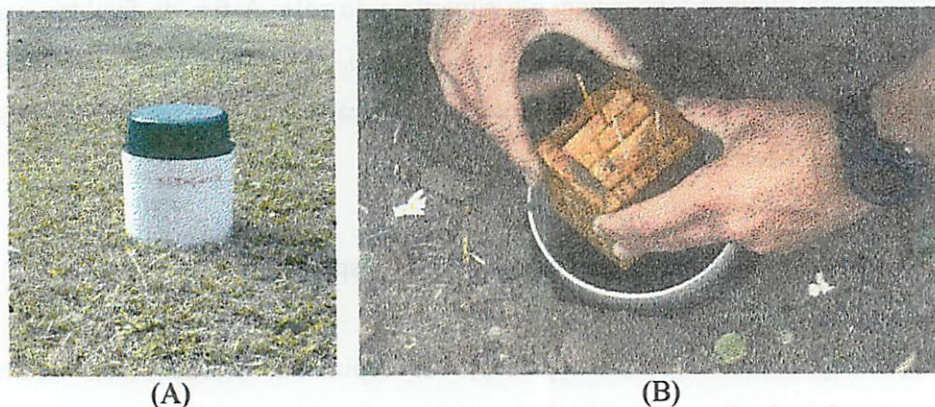
FIGURA 4 (A) Estação de monitoramento antes de ser introduzida na área experimental. (B) Bloco de madeira contendo pinos roliços de madeira sendo introduzido na estação de monitoramento.
