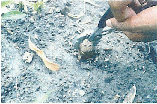
FIGURA 1A Inspeção das estacas de pinho no campo, retiradas com o auxílio de um alicate.
