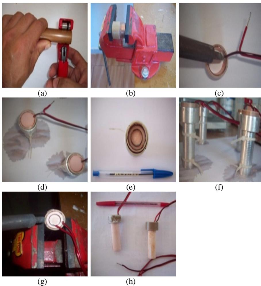
Figura 4 Etapas da construção dos capacitores: cortador de cobre (a), inserção do eletrodo externo (b), soldagem de fio paralelo-eletrodo externo (c), preenchimento das fôrmas (d), inserção do eletrodo interno (e), período de secagem (f), solda de fio paralelo-eletrodo interno (g), capacitores cilíndricos (h)
