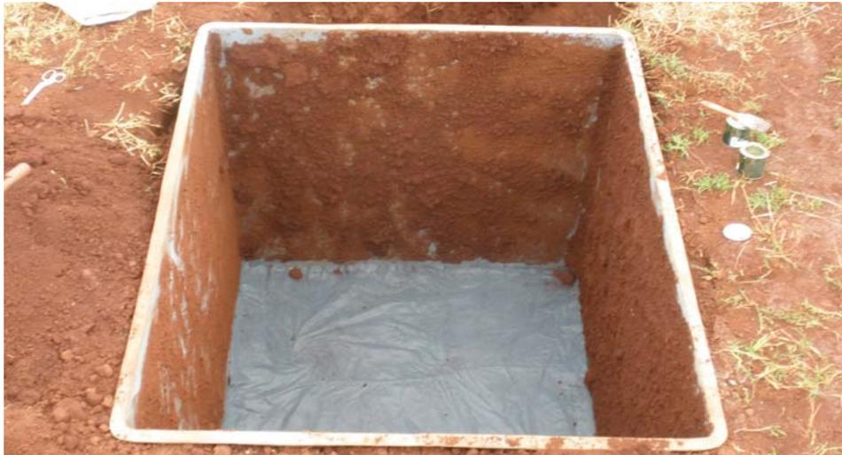
Figura 6 Face interna das paredes do tanque recobertas com cola adesiva e uma fina camada de solo, com a manta sintética estendida sobre a brita ao fundo
