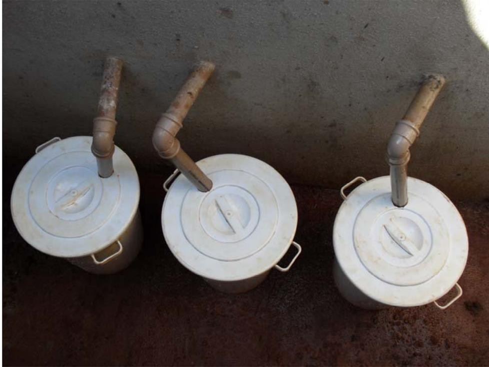
Figura 8 Detalhe dos baldes de coleta dentro do poço coletor dos lisímetros
