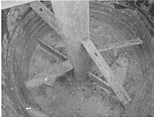
FIGURA 6. Vista das palhetas internas da maromba.
