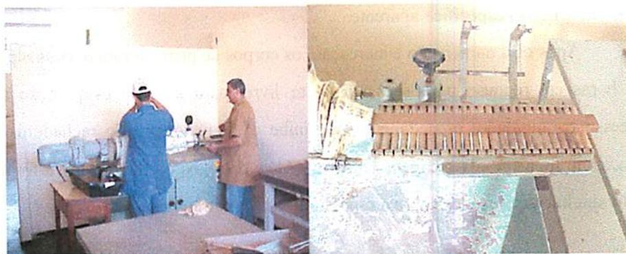
FIGURA 2.1- Extrusão dos corpos de prova.
