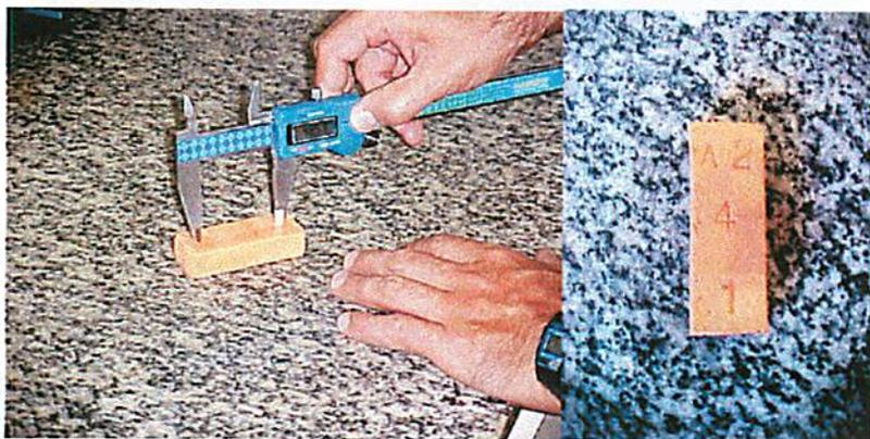
Figura 2.2 – Marcação e numeração dos corpos de prova.
